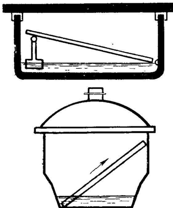
Рис. 22. Хроматографические камеры с пластинкой
