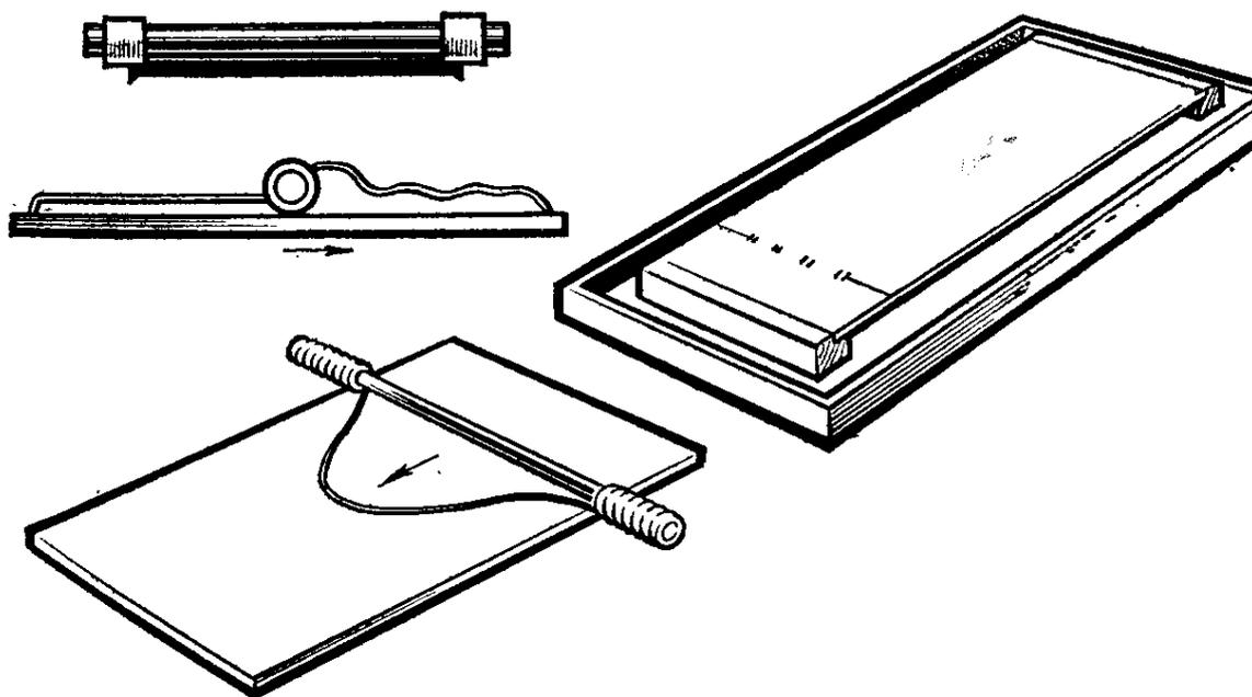
Рис. 21. Нанесение сорбента на пластинку и станок для пластинок
